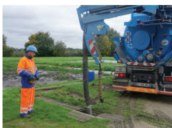
Camion combiné aspirateur/hydrocureur avec bras multifonctions automatisés
